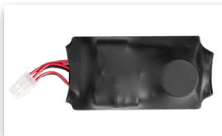
EM-VWF3: Frequenzweiche für die Mittel-/Hochtöne mit 12 dB Filter @ 600 / 5700 Hz
